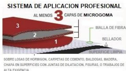
Mezcle el contenido del balde y si lo cree necesario, se puede agregar hasta ½ litro de agua. Extienda la malla de fibra sobre la superficie y vierta una cantidad de **MicroGoma** sobre la malla. Estire el producto con el rodillo, pincel, llana o incluso un buen secador de piso. Se debe presionar y dejar poco producto, el cual generará que la malla se adhiera a la superficie. Pasadas 4 horas, se puede aplicar la segunda mano de manera
