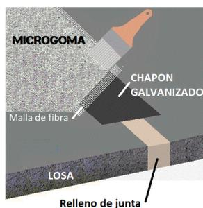
**La junta mas segura** Colocando un chapón de chapa galvanizada sobre la junta de dilatación se solucionan los grandes movimientos. Sobre la junta ya rellena con un elastómero, coloque una capa liviana de **Microgoma** e inmediatamente apoye el chapón a lo largo de la junta, el cual quedará adherido. Luego proceda a colocar la malla de fibra en toda la superficie y recúbrala con la primera mano de **Microgoma**
